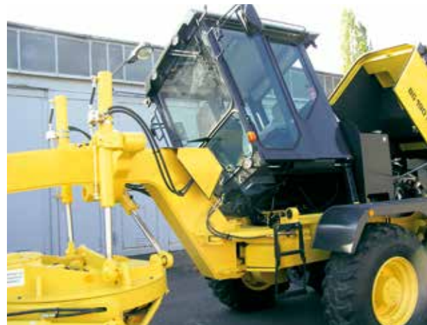
Très bonne accessibilité à tous les organes grâce à la cabine et au capot moteur basculants.
