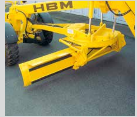
La cinématique raffinée permet le réglage rapide et optimal de la lame de nivellement
