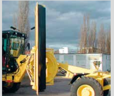
Couronne d'orientation fermée avec guidage par roulements. Angle d'inclinaison de la lame à 90° vers la gauche et la droite.
