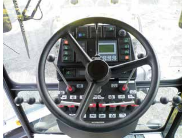
Visibilité panoramique et pupitre commande Euro. Pupitre de commande NAIS (tringlerie) ou de joystick sur demande.
