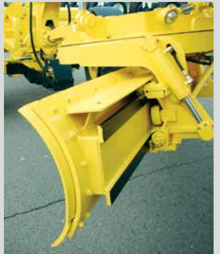
Réglage hydraulique en continu de l'angle de coupe
