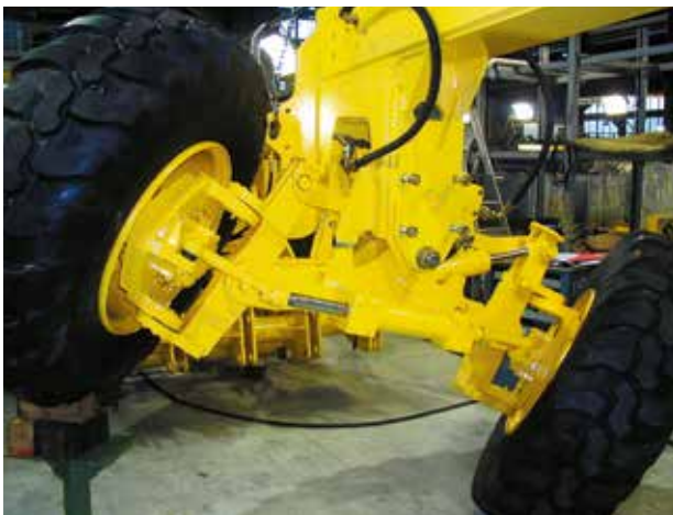
Essieu AV entraîné avec carrossage
